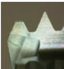
エポックDスレッドミル30穴加工後の工具状態 Tool condition of Epoch D Thread Mill after machining 30 holes
