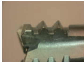
エポックDスレッドミル 150穴加工後の工具状態 Epoch D Thread Mill after threading 150 holes.
