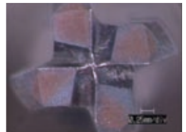
エポックDスレッドミル 400穴加工後の工具状態 Epoch D Thread Mill after threading 400 holes.
