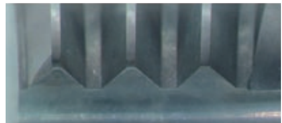
エポックスレッドミル 400穴加工後の工具状態 Epoch Thread Mill after threading 400 holes.
