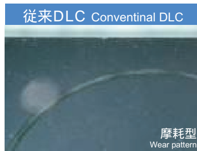
ボールオンディスク摩擦試験後の表面観察 Examination of surface after ball-on-disk friction test
