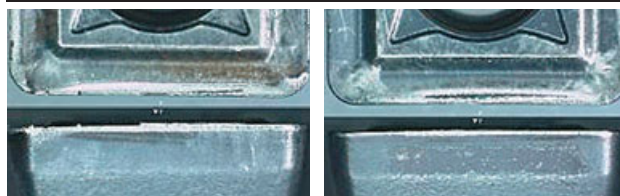
チップ摩耗幅の写真(5穴加工時点) Photo of insert wear width (after 5 holes)
