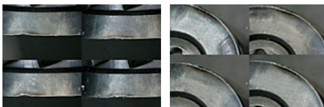
67.2m加工後のチップの写真 photo of after milling 67.2m
