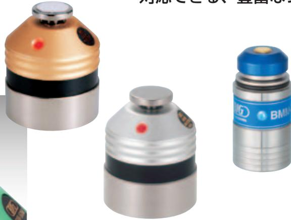
繰り返し精度  $1\mu\text{m}(2\sigma)$ 。加工物上面の刃先位置を検出し、LEDにて伝達。
