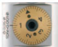
試し加工後、微調整ディスクにて最終加工径に調整。
