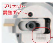
プリセット・調整ギアでプリセット目盛りを加工径に合わせるだけの簡単プリセット。
