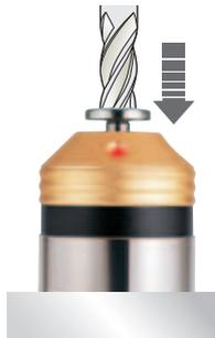
刃具径  $\phi 0.05\text{mm}$  の刃先位置検出
