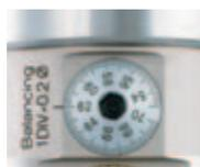
バランスウエイト・調整ディスクの目盛りを加工径に合わせ、クランプスクリュを締め付けるだけで最適なバランスに。
