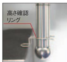
高さ確認リングにて測定位置のZ位置を確認(付属品)
