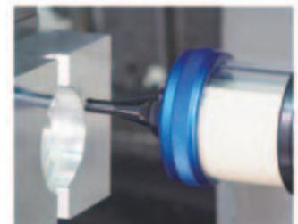
機械主軸テーパの汚れを自動清掃。高精度加工のFA化の必須アイテム。
