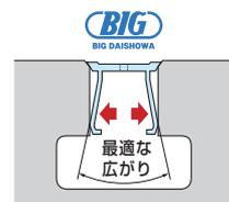
テーブル溝に接する部分が独自の角度形状のため、抜けにくく、切りくずを完全にシャットアウトします。
